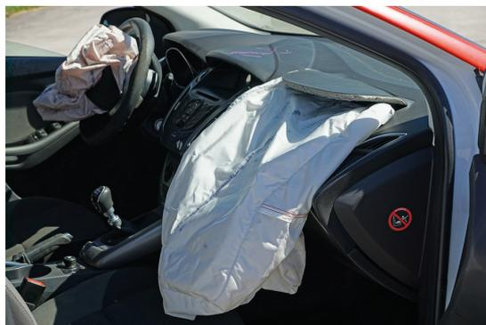
El cinturón de seguridad es el elemento más vital del vehículo, y el airbag fue inventado como complemento del cinturón. De esta forma, el airbag reduce las lesiones secundarias en un 30%. Para eso es esencial un buen uso de estos sistemas.
