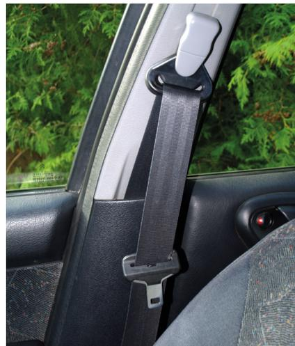
La banda del cinturón está formada por un **trenzado**, compuesta de poliamida, lo que permite que sea más flexible y adaptarse al tamaño del ocupante. Esta banda funciona de tal manera que presenta un **comportamiento rígido a la tensión**. Esto
